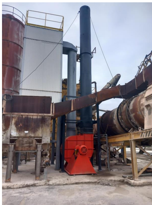
Слика бр. 9. - Изведен филтерски систем за отпрашување на димни гасови
