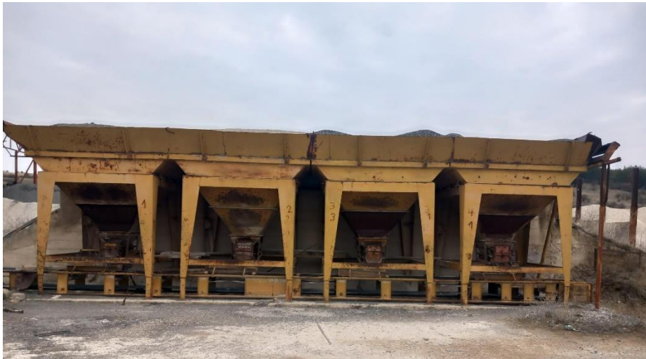
Слика бр. 5. - Бункери за различни фракции камен материјал (ризла) со димензии од 0-4, 4-8, 8-16 и 16-22 mm. Бункерите се поврзани со транспортна лента за дозирање на ризлата во ротационата сушара
