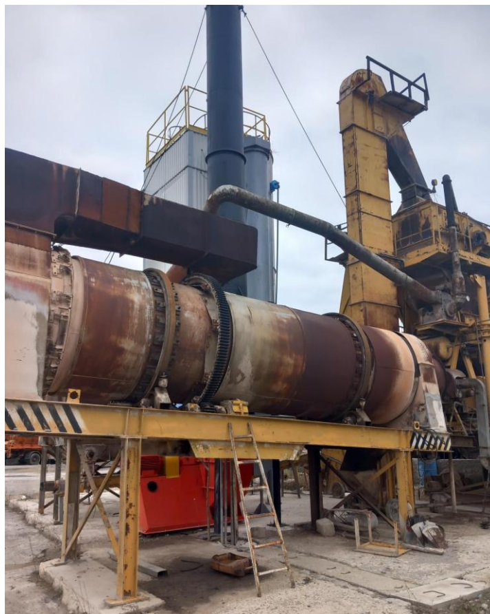
Слика 3. Асфалтна база – Подружница Штип при ЈП за одржување и заштита на магистралните и регионалните патишта – Скопје ц.о. Проектиран капацитет: 40 t/h.
