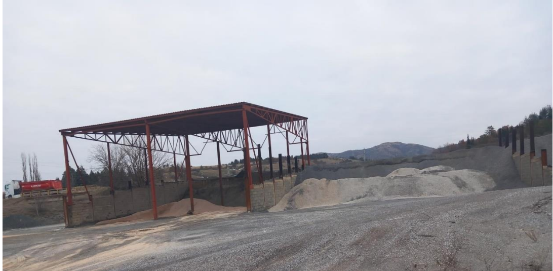
Слика бр. 4. - Покриен и откриен склад за фракции од камен материјал (ризла)
